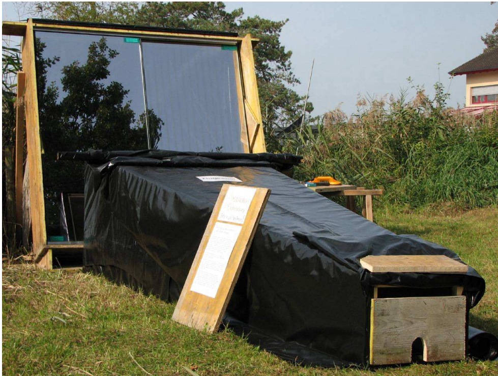
Abbildung 3: Flugkanal im Garten der Vogelwarte. Durch Schiefstellung der Scheiben gelangt sehr viel Licht auf deren Oberfläche. Schlitz für Beobachtung und Videoaufnahmen, sowie Loch zum Freilassen der Vögel sind unten rechts im Bild zu sehen. © Dieter Peter
