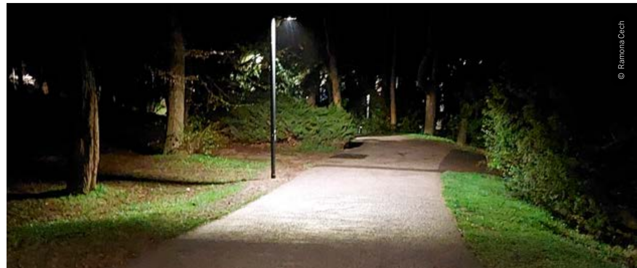
Hier strahlt das Licht nach unten und hellt den Nachthimmel nicht auf.
